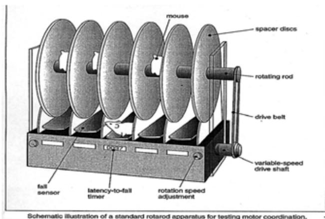
Fig: 2 Rotarod apparatus.
